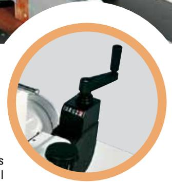
Fräsanschlag mit Verstellung über Handrad, mit linearer stufenloser Regulierung zum Verschieben des gesamten Anschlags und nur für den Einlaufanschlag. Die Verschiebung wird über mechanische Digitalanzeigen angezeigt. Die seitlichen Griffe erleichtern die Abnahme vom Arbeitstisch.
