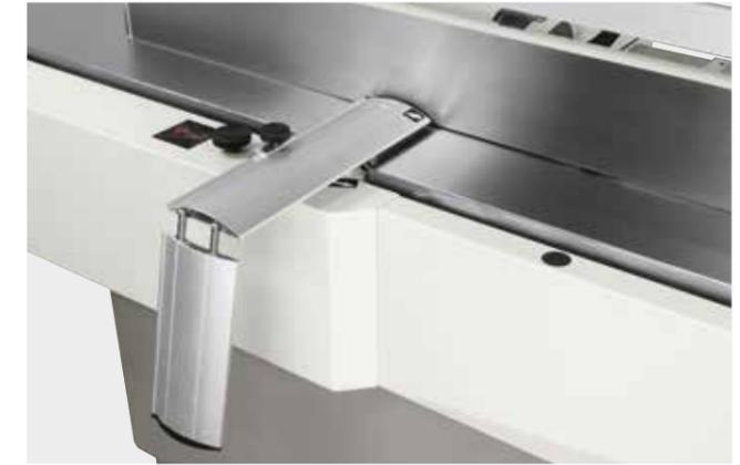
The safety guard is foldable in relation to machining requirements. This protection system has been designed to ensure best safety for the operator. Die Schutzvorrichtung ist klappbar und wurde konzipiert, um höchsten Schutz für den Bediener zu gewährleisten.
